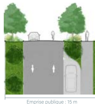
Rue publique avec trottoir et espace de stationnement constitués de matériaux perméables (Apur, 2022)
